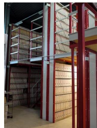
Les rayonnages sont de type autoporteur. La capacité d'archivage totale du dépôt est d'environ 12 000 mètres linéaires.
